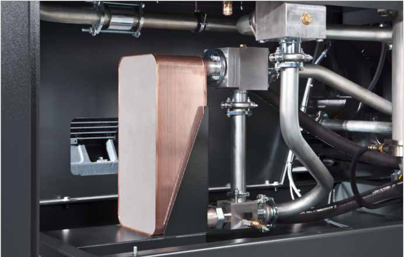
Abb.: Innenaufbau eines Kompressors – System aus Plattenwärmetauscher, Thermoventil und kompletter Verrohrung
