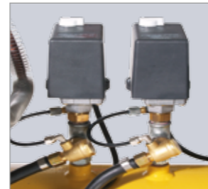
Zwei Druckschalter Entlasteter Anlauf der Kompressoren ohne Gegendruck; Ein-/Ausschaltdruck für jeden Kompressor separat einstellbar.
