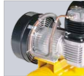
Direktgekuppeltes Aggregat Antriebsmotor direkt am Kompressorblock; robust und langlebig dank niedriger Drehzahl von nur 1500 U/min.
